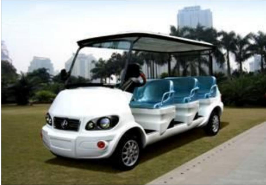
高尔夫球车维护：切忌亏电存放，亏电状态指电动高尔夫球车，电动观光车，电动餐车电瓶使用后没及时充电，容易出现硫酸盐化，硫酸铅结晶物附在极板上，堵塞电离子通道，造成充电不足，电瓶容量下降。亏电状态闲置时间越长，电瓶损坏越严重。电瓶闲置不用时，应每月充电一次，这能延长电瓶使用寿命；要定期检验，在使用过程中，如果电动高尔夫球车的续行里程在短时间内突然下降十几公里，则很有可能是电瓶组中至少有一块电池出现断格、极板软化、极板活性物质脱落等短路现象。此时，应及时到专业电瓶修复机构进行检查、修复或配组；勿大电流放电，尽量避免瞬间大电流放电。大电流放电容易导致硫酸铅结晶，从而损害电瓶极板的物理性能；掌握充电时间，一般情况下蓄电池都在夜间进行充电，平均充电时间在8小时左右。若是浅放电（充电后行驶里程很短），高尔夫球车电瓶很快就会充满，继续充电就会出现过充现象，导致电瓶失水、发热，降低电瓶寿命。电动高尔夫球车购买时应该注意哪些？吉林电动巡逻车厂家直销
