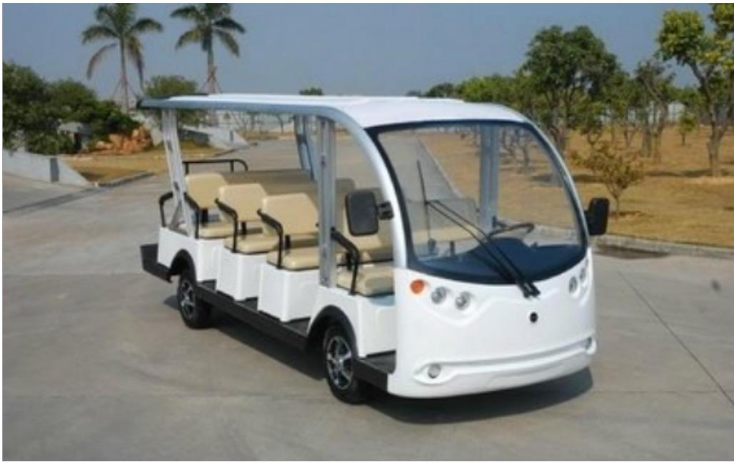
高尔夫球车特点：前桥、后轴：麦弗逊式前悬架。该悬架可增大驾驶室内空间，提高整车操纵稳定性；转向系：方向盘高度和倾斜度可调；电气：仪表监控系统。红色仪表盘透射照明，电子脉冲传感器的车速里程表，整体控组合仪表，装有多功能指标器；舒适装置：活动顶窗，设有摇把，可应急关闭。驾驶高尔夫球车时应保持匀速行驶，以避免由于加速发出较大噪音。行车时应时刻关注周围的打球者。一旦发现有人正准备击球，就必须停下来，等到击球之后再发动球车继续行驶。
